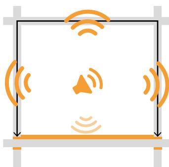
El sistema de construcción de la solera flotante reduce la propagación del ruido a través del forjado. El uso de bandas resilientes de desacople reduce la propagación del ruido aéreo por vía estructural.
